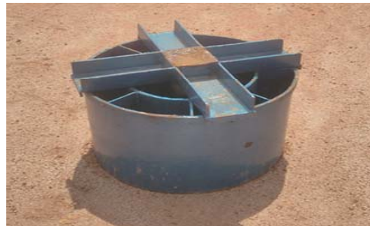
Fig. 2.1 : Double Ring Infiltrometer
