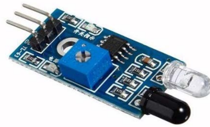
Fig: Infrared sensor
